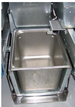
Obrázek 3: Vložte vnitřní zásobní nádobu oleje do rozpouštěče.
