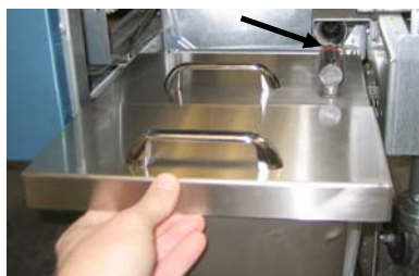
Obrázek 4: Položte víko na nádobu a zasuňte spojku sací trubky oleje do protikusů.
