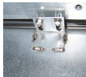
Obrázek 5: Upevněte rozpouštěč ke kolejnicím na obou stranách.
